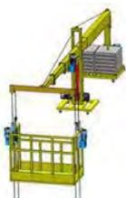
✓ **Andaimes em balanço** – são estruturas que se projetam para fora da edificação, sendo suportadas por vigamentos (que podem ser metálicos ou de madeira) ou por estruturas em balanço. Podem ser deslocáveis ou fixos e são utilizados na construção civil, sobretudo quando não é possível optar por outros tipos de andaimes.
